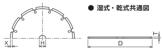
DREL : コンクリート・ヒューム管・陶管・耐火物・U字溝・石材・瓦・スレート等の被削材
